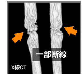
図6：導線が損傷している様子(例)
