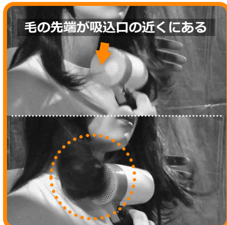
図4：吸い込み口から人工毛が吸い込まれる様子（再現実験）
